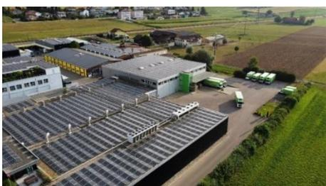
2012 wurde auf dem Dach des Neubaus eine Photovoltaikanlage installiert. Diese umfasst eine Fläche von 3'800 m<sup>2</sup> und produziert jährlich ca. 600'000 kWh Strom. 2023 wurde die Anlage um eine Solarfassade und weiteren Dachflächen erweitert. Daher ist eine zusätzliche Produktion von 800'000 kWh Strom möglich. Der insgesamt produzierte Strom von 1'400'000 kWh entspricht
